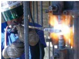
ガス溶接は、ガスバーナーを利用して金属をつなぎ合わせたり、切断するための技術で、さまざまな現場で広く活用されています。これらの作業中に、装置の欠陥や取扱いに誤りがあると、大きな爆発や火災につながることも。それを防ぐためにも、可燃性ガスを使った金属の溶接・溶断・加熱の作業を行うには、ガス溶接技能講習を受講する必要があります。
