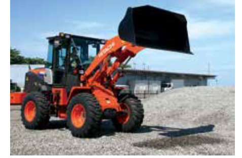
タイヤショベル 力強く土砂をすくい運ぶ重機。操作性が高く、建設や除雪に活躍。
