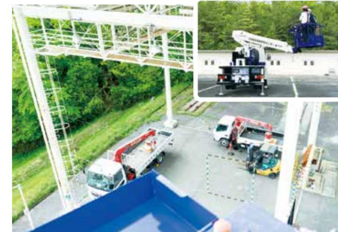
「高所作業車運転技能講習」は、作業床の高さが10m以上での高所作業車の運転(道路上を走行させる運転を除く。)の業務を行う場合に必要資格。実務経験がなくても安全に受講できる。
