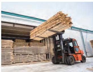
建設資機材の搬入・搬出の際に、最大荷重1t以上の資材を指定された場所へと運ぶためのフォークリフトの運転操作に必要な資格です。
